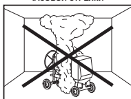
РАБОТАТЬ ТОЛЬКО В ХОРОШО ПРОВЕТРИВАЕМЫХ МЕСТАХ. ВЫХОДЯЩИЕ ГАЗЫ МОГУТ УБИТЬ
